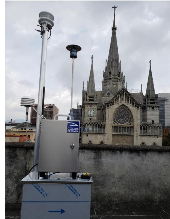
Analizador automático de partículas PM<sub>10</sub> y PM<sub>2.5</sub>, estación Gobernación. Método óptico (nefelómetro)
