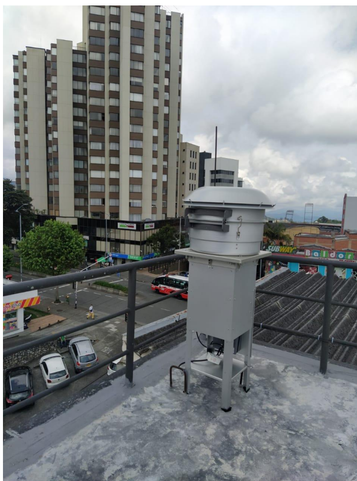
Equipo Hi-Vol Manual / Estación Católica La Estrella / Manizales, Caldas
