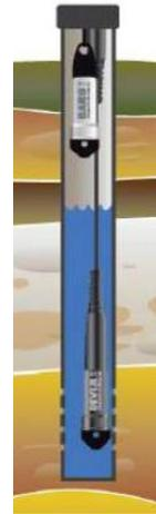
Figura 4: Configuración Diver y Baro - Diver dentro de un pozo de monitoreo.
