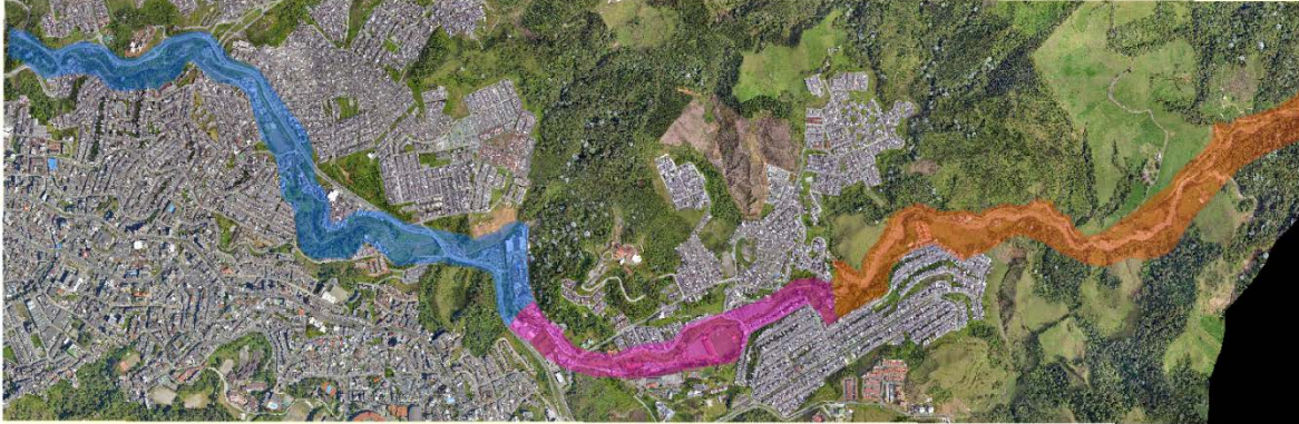
Figura 100. Definición de tramos quebrada Olivares para la modelación hidráulica.
